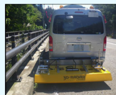
車載式電磁波レーダによる床版の計測
