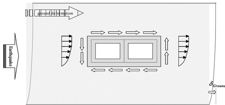
**FIG.1. UNDERGROUND STRUCTURES UNDER SEISMIC LOAD**
