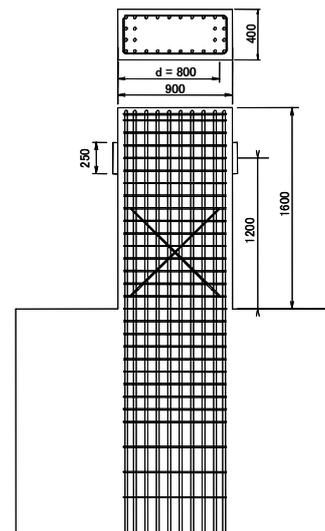
**FIG.10. DETAIL OF SPECIMENS**
