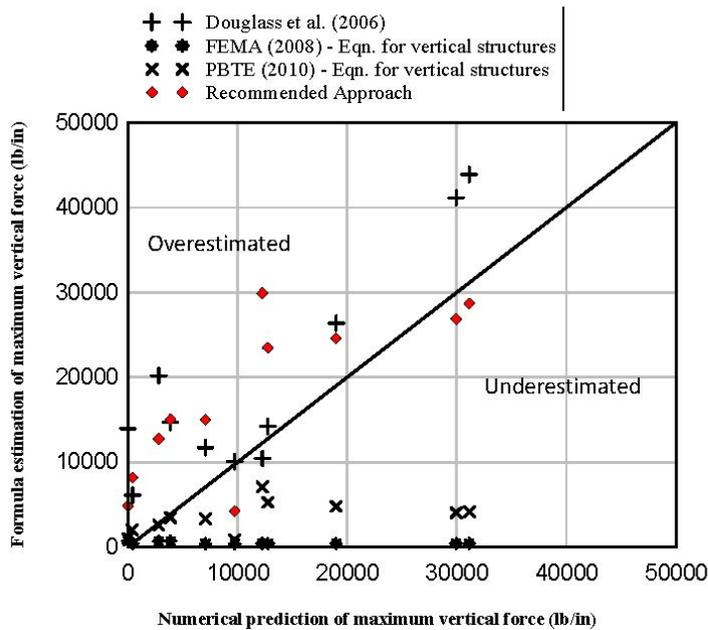
FIGURE 9, COMPARISON OF NUMERICAL PREDICTION OF VERTICAL FORCE VERSUS RECOMMENDED FORMULA ESTIMATE
