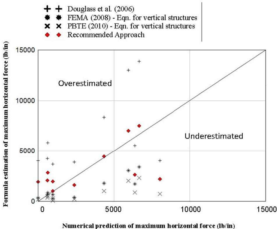
FIGURE 7, COMPARISON OF NUMERICAL PREDICTION OF HORIZONTAL FORCE VERSUS RECOMMENDED FORMULA ESTIMATE
