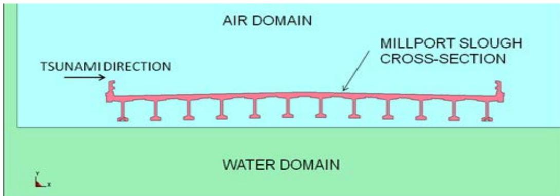
FIGURE 1, MILLPORT SLOUGH EXAMPLE SIMULATION MODEL
