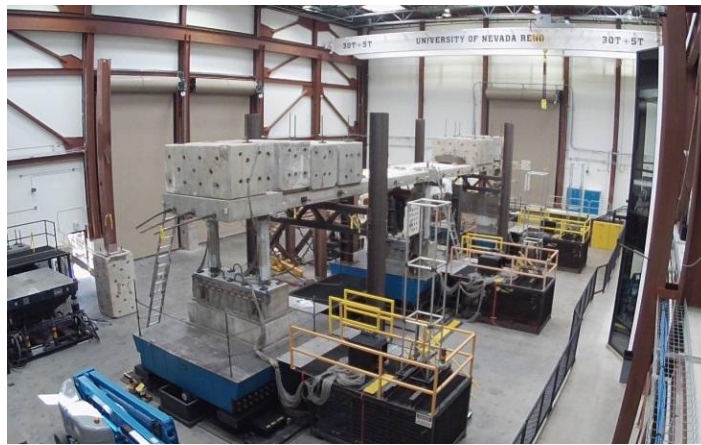
Fig. 1. Shake table specimen
