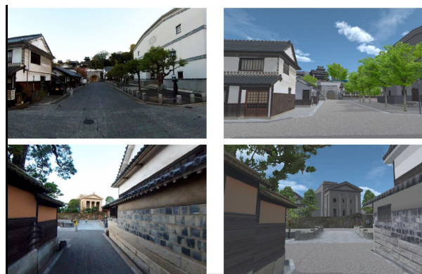
写真 3-2 倉敷市における LOD 3 建築物等の再現精度検証 (左：実際の建物群、右：仮想空間での再現)
