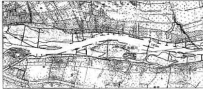
ケレップ水制設置状況図(1909年利根川改修計画図)
