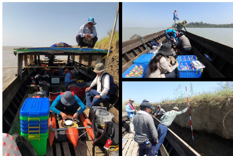
写真 3-22 ADCP ボートを用いた試料採取と測量
