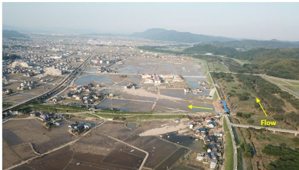
写真 1 小田川の破堤(倉敷市真備町、ドローンで撮影)
