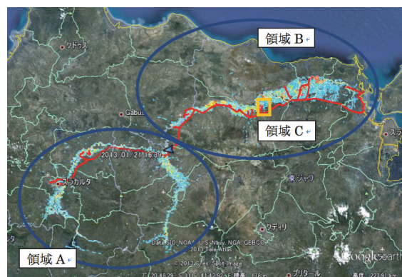
図 19 ソロ川流域における氾濫状況の解析結果
