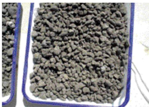
写真 - 1 排水性舗装から採取した再生骨材
