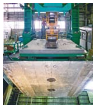
模擬損傷床版の輪荷重走行試験
