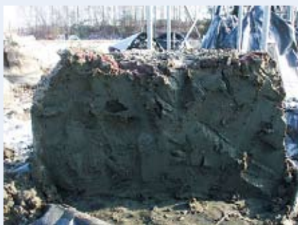
(c)凍結した大型土のう内部
