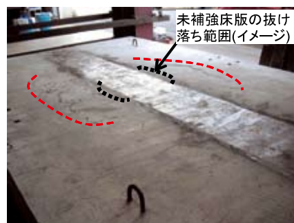
鋼板接着補強された鉄筋コンクリート床版供試体の抜け落ち範囲
