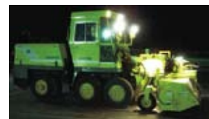
写真7.12 ブラシ式除雪試験装置
