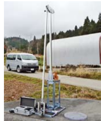
集水井内点検カメラ
