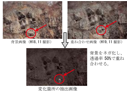
図6.2 背景差分法の変状箇所抽出概念図
