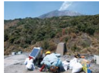
自動降灰量計の設置状況
