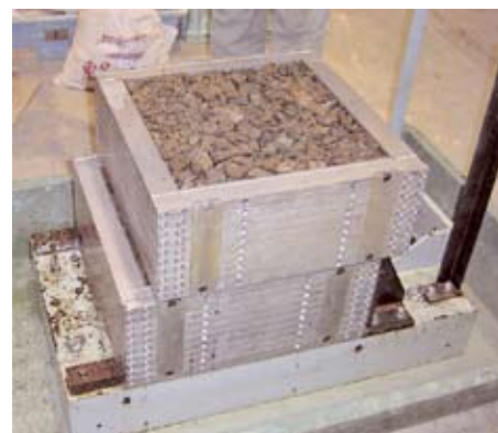
大型一面せん断試験実施状況
