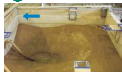
図14.9 排砂実験後(排水後)の状況
