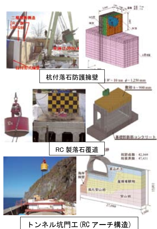
図6.4 衝撃実験及び数値解析モデル例
