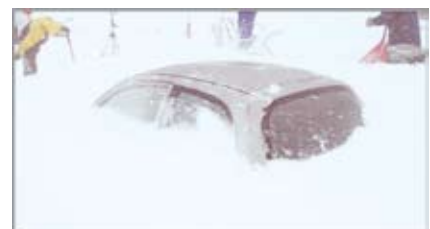
吹きだまりによる排気管閉塞状況
