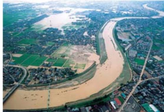
図2.1 平成16年新潟豪雨洪水災害における五十嵐川の破堤
