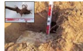
写真7.11 生育不良木の根茎と周辺地盤の滞水の調査状況
