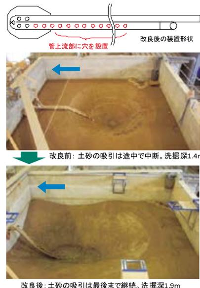
図14.9 排砂実験後(排水後)の状況
