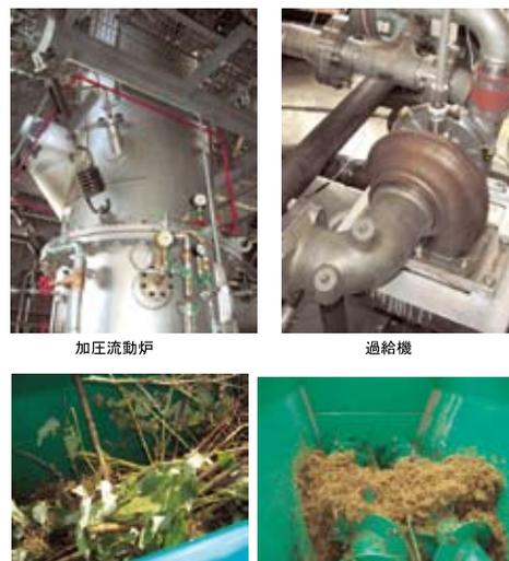
図12.3 新たなバイオマスエネルギー転換技術の開発(過給式流動燃焼システム)
