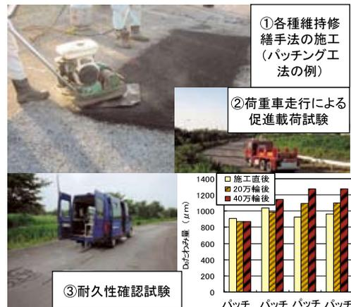
図10.5 耐久性確認試験結果の例
