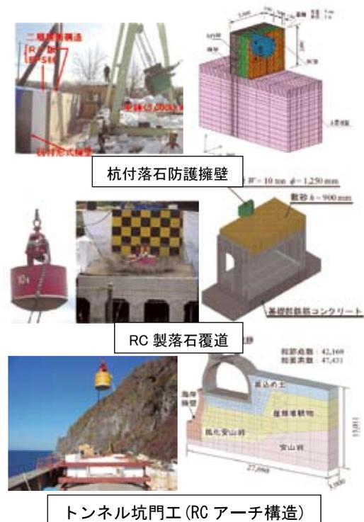
図6.4 衝撃実験及び数値解析モデル例
