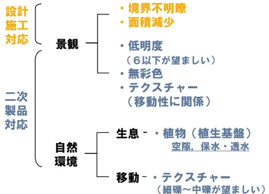
図13.4 護岸工法の性能評価手法
