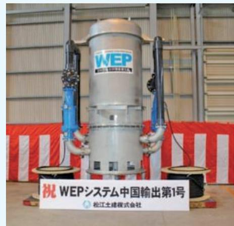
写真 -1 中国に設置される気液溶解装置
