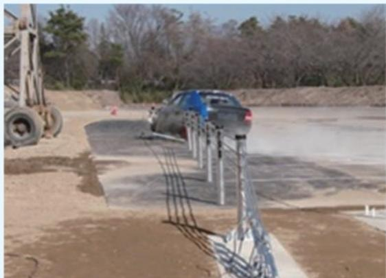
写真-1 防護柵の衝突実験
