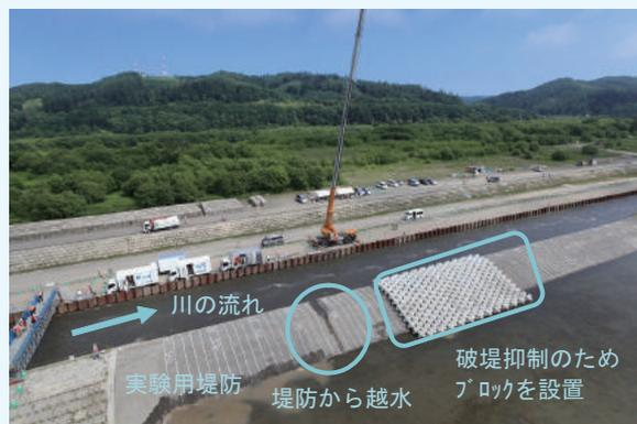
写真-1 水位が上昇し堤防から越水
