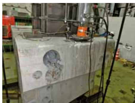
縁端拡幅補強部の耐荷力試験
