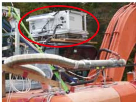
設置した車載型排出ガス計測装置の様子
