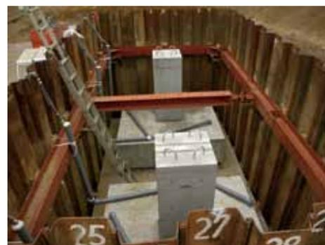
暴露試験状況（埋設及び死荷重作用前）
