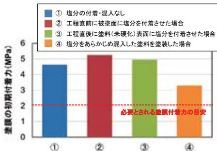
Rc-I 塗装系塗膜(はけ塗り)の初期付着力に及ぼす塩分の影響(塩分量150mg/m<sup>2</sup>程度)
