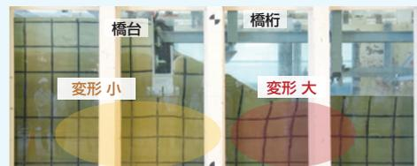
写真-4 加震後の地盤の残留変形状況
