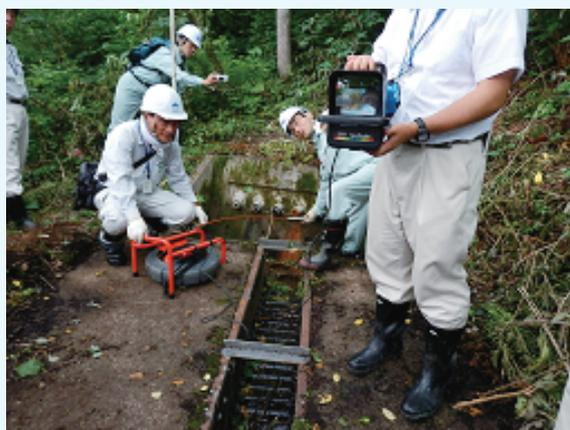
写真-2 集水管内観察カメラの実演状況
