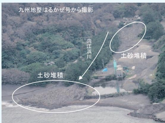
写真-3 向江浜川の土石流発生状況
