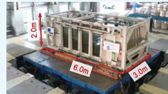
写真-3 三次元大型振動台と大型剛土槽
