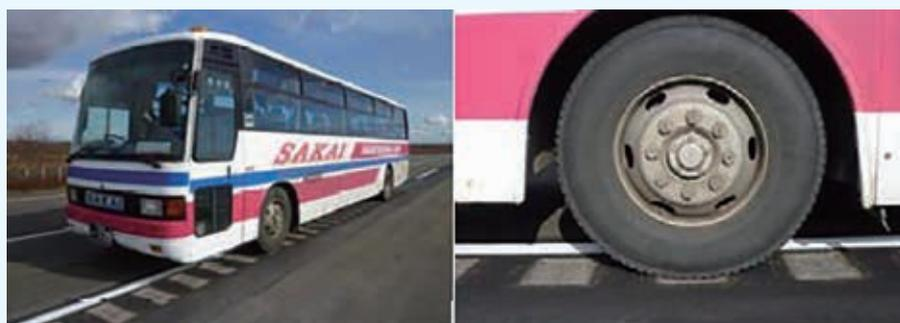
写真-1 大型車対応ランブルストリップ
