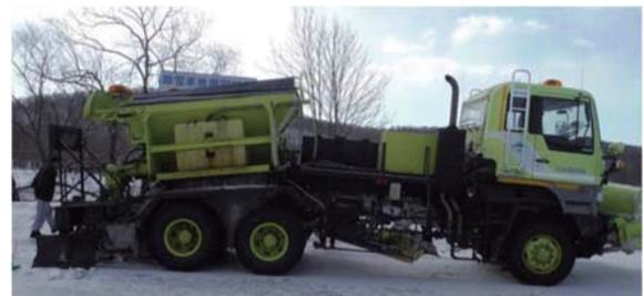
図-3 老朽化が著しい除雪機械
