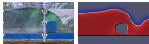
図-8 ゲート周辺部の水理模型実験と数値計算結果
