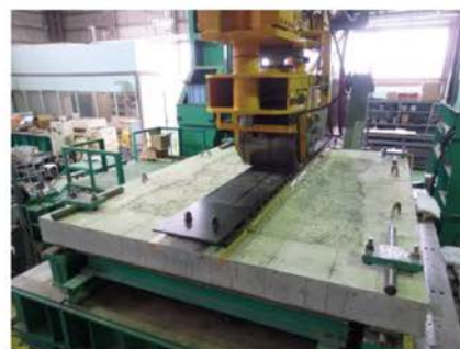
写真-3 撤去床版の疲労载荷試験の状況
