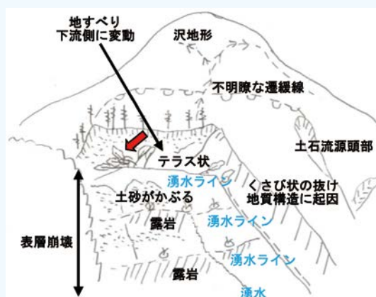
図-1 小野地区斜面崩壊の現地調査結果
