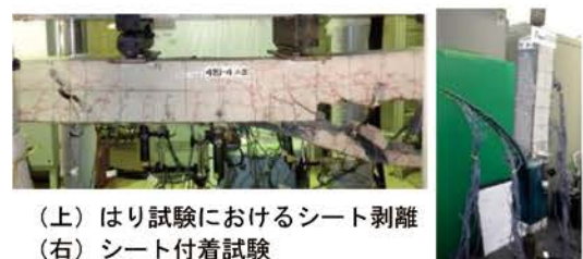
図-10 シート補強試験体の試験状況
