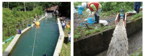
図-7 施設運用しながらの排砂実験状況
