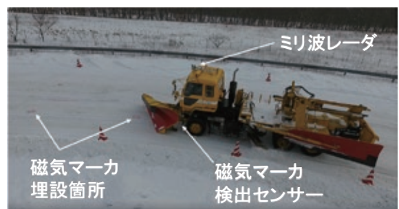
図-11 自車位置推定実験(路面整正作業時)
