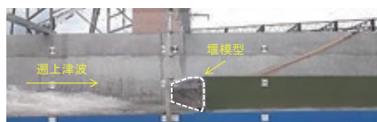
図-3 浸透模型実験で確認された崩壊の進行
