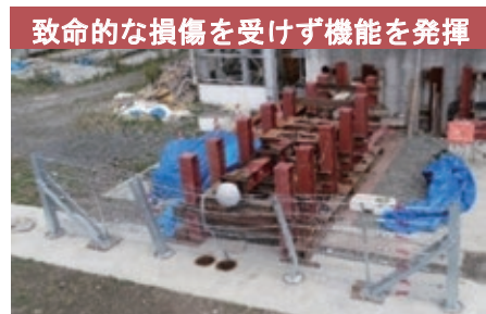
(従来型落石防護柵の静的載荷実験後) 図-3 土砂災害の防止・軽減のために開発する設計技術
