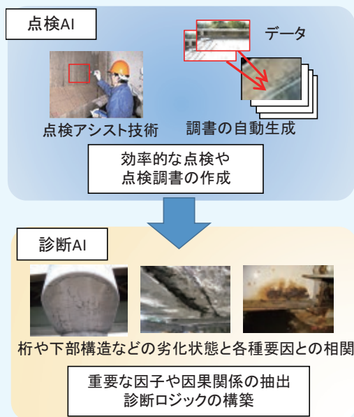
図-1 点検AI・診断AIの概要
