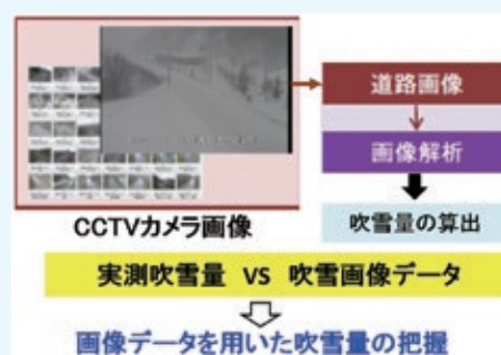
図-2 画像解析による吹雪量の推定
