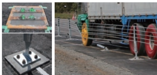
図-9 コンクリート定着方式と衝突試験
