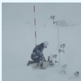
写真-1 吹雪量の現地実測
