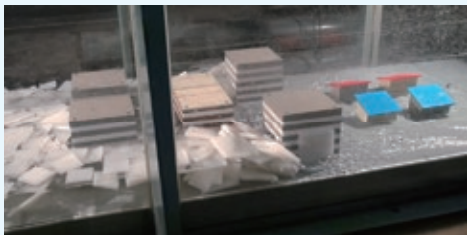
写真-2 海水を伴う津波の水理模型実験
