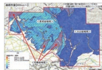
図-6 降雨による崩壊発生率分布図の例
