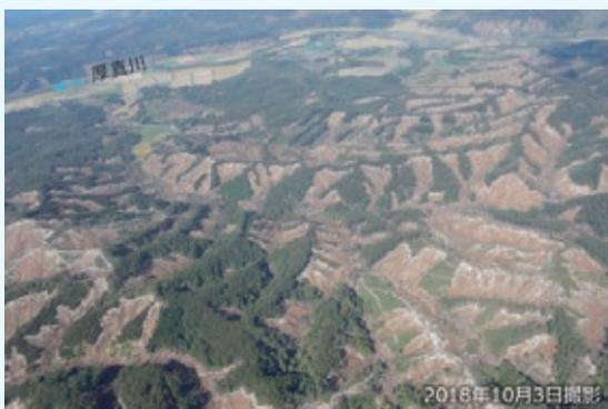
写真-1 厚真川流域で発生した多数の表層崩壊
