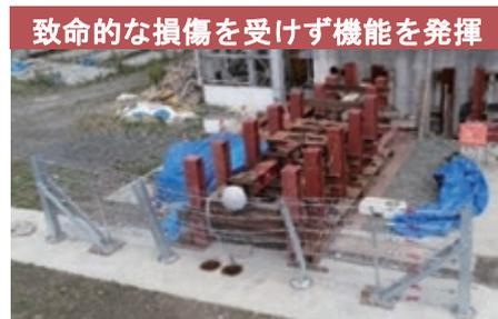
(従来型落石防護柵の静的載荷実験後)
