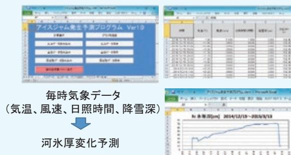
図-1 エクセルによる河水厚予測プログラム
