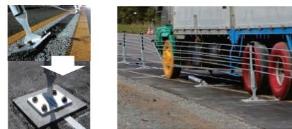
図-10 中小橋梁への新たな固定方式(左)と衝突実験(右)
