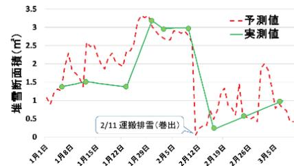
図-6 堆雪断面積推移の例(札幌)
