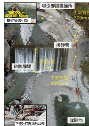
図-6 水位差12mの現地実験の様子
