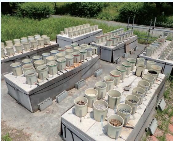
写真-1 土研式雨水曝露試験
