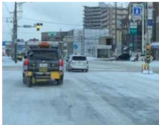
図-5 冬期走行環境悪化時の路面すべりやすさ、平坦性、有効幅員および走行速度の同時計測（二十四軒手稲通）
