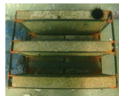
図-9 コンクリート製試験礁の概要
