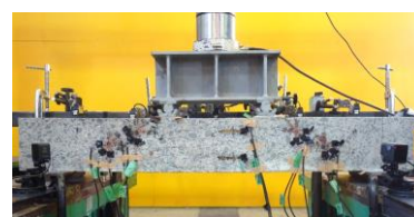
写真-1 損傷部材の実験状況
