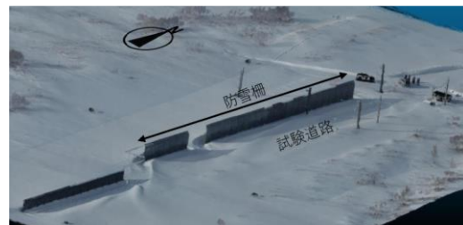
図-4 柵周辺の積雪状況(3次元点群データ)
