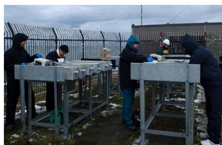
図-1 共同研究者とのひび割れ補修試験体の暴露測定状況 (増毛暴露場)
