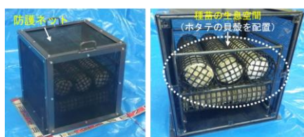
図-1 ナマコのゆりかごの外観（左）と内部構造（右）
