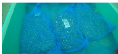
図-2 実験に用いた海底基質試験体 （網袋に砂利を詰めた試験体を根固ブロック上の大型バット内に設置）
