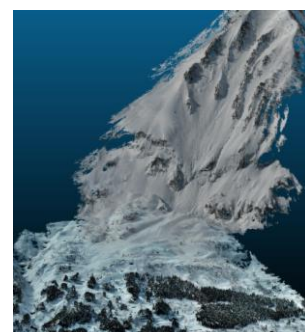
図-3 UAV調査で取得した雪崩 斜面の三次元点群データの イメージ
