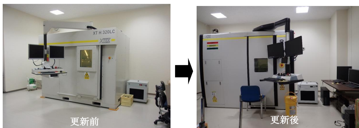
写真-8.1.1.3 土木地質材料非破壊分析設備更新（つくば）
