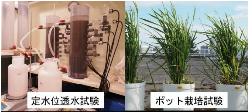
図-6 濁水取水の影響評価試験
