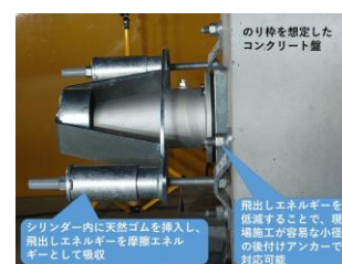
図-5 アンカー飛出し防御装置
