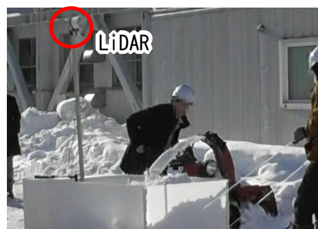
写真-2 積込形状認識模擬実験状況
