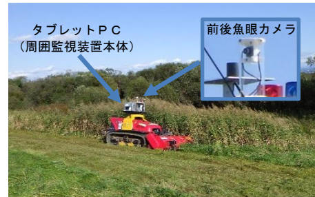
自動運転試験中の草刈機および周囲監視装置
