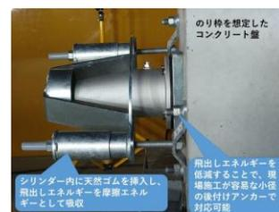
図-5 アンカー飛出し防御装置
