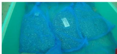
図-2 実験に用いた海底基質試験体
