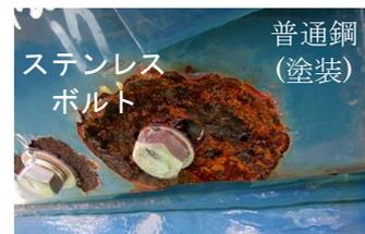
写真-2 異種金属接触腐食の例
