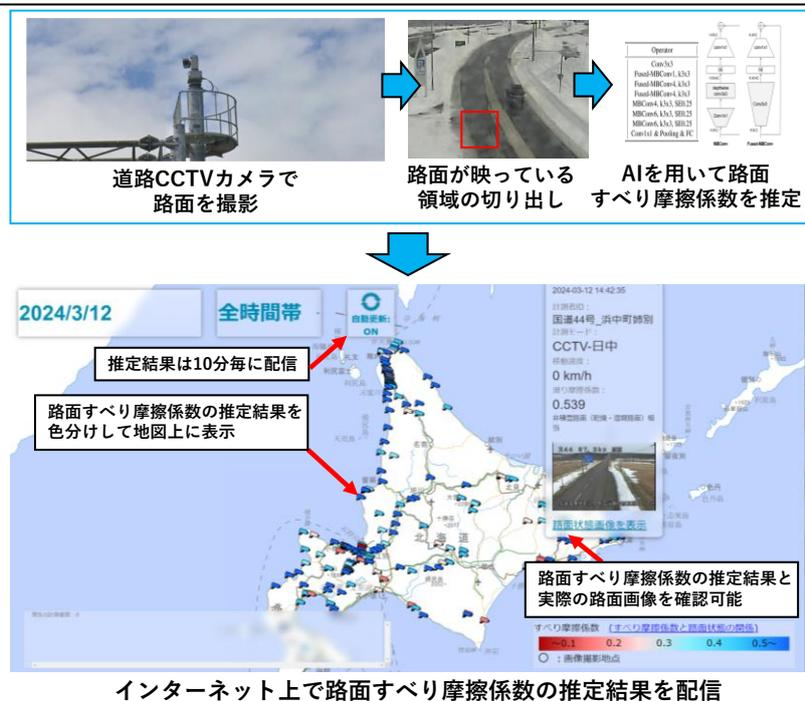
道路 CCTV カメラと AI を用いた路面すべり摩擦係数推定・配信システム
