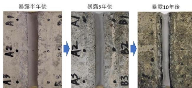
図-2 有機系充填材の劣化進行の一例（増毛暴露場）
