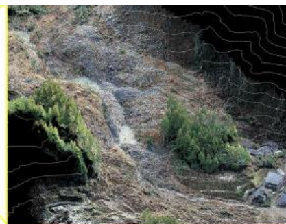
北陸地整TEC-FORCE撮影のUAV画像から作成したBIM/CIMモデル
