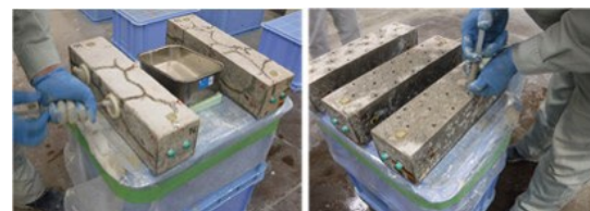
ASR が生じたコンクリート部材へのゼオライトによるひび割れ注入および孔充填の様子
