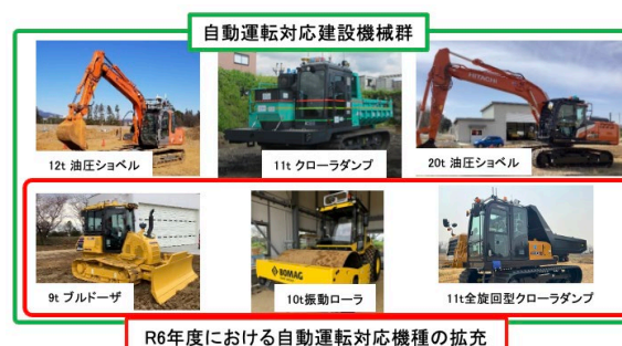
図-1 自動運転対応建設機械群
