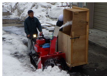
排雪重量計測試験状況
