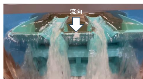
PKW 模型実験（下流側より望む）
