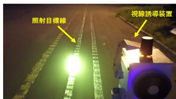
視線誘導装置の動作試験状況
