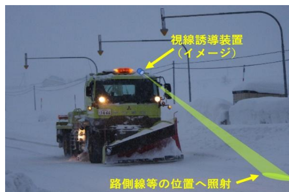
除雪車に取り付けた視線誘導装置の動作イメージ
