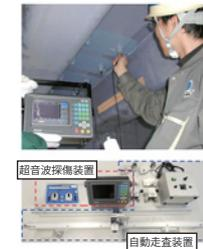
近年、鋼床版橋梁においてデッキプレート内に進展するき裂が見つかっています。このき裂は、目視点検では直接確認することが困難な部位に発生するため、超音波探傷による非破壊調査技術が求められています。本講演では、臨界角の斜角探触子を用いて、客観性・信頼性の高い超音波調査技術を開発したのでその概要を紹介します。
