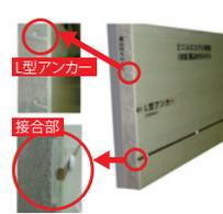
工場で引抜成形されたFRP(繊維強化プラスチック)パネルを埋設型枠として用いることで、防食性や施工性に優れた、比較的安価なコンクリートの表面被覆工法を開発しました。本技術は、過酷な劣化環境にある下水処理施設等のコンクリート防食に、特に適しています。本講演では技術の概要のほか、下水処理施設への適用を想定した各種性能試験の結果や、適用事例等を紹介いたします。
