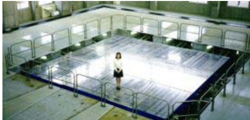
振動実験施設(三次元大型振動台)
