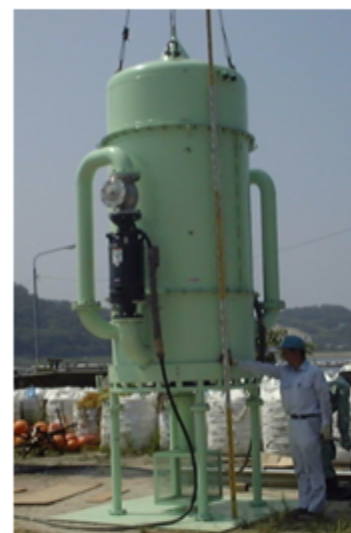
気液溶解装置 吐出流量: 120 m 3 /h φ: 1,200 H: 4,000
