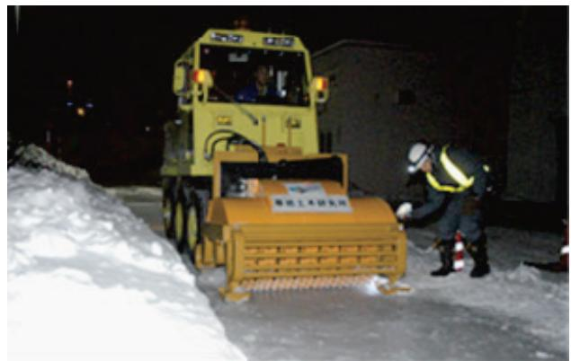
図-5 歩道雪氷路面処理装置
