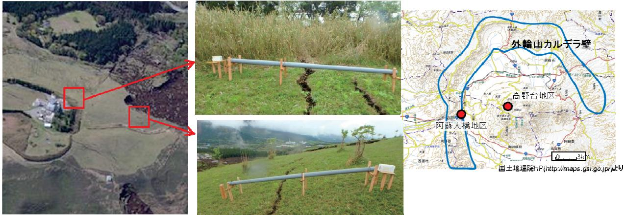
写真-7 高野台地区の亀裂（亀裂の幅を観測する伸縮計を設置）
