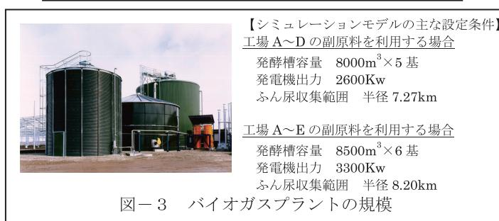
図-3 バイオガスプラントの規模
