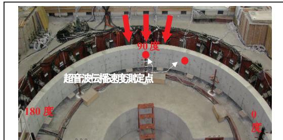
(a) 実大規模の覆工コンクリート載荷試験
