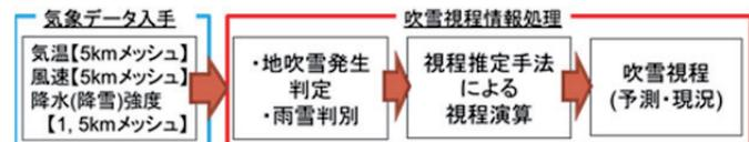
図-4 吹雪視程情報処理プロセス
