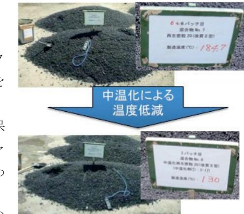
写真-1 実プラントでの製造温度低減効果の検証
