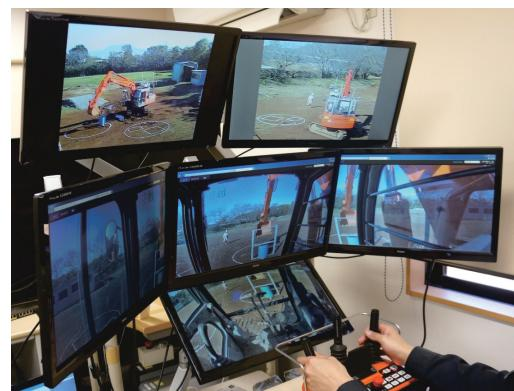
図-13 無人化施工のために新たに提案した操作用のモニター
