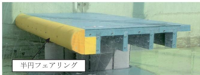
写真-4 半円フェアリングを設置した模型
