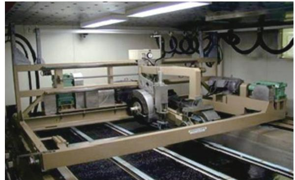
図-2 室内凍結路面走行試験装置
