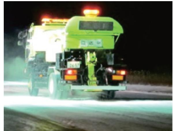
図-3 防滑材加熱水混合散布
