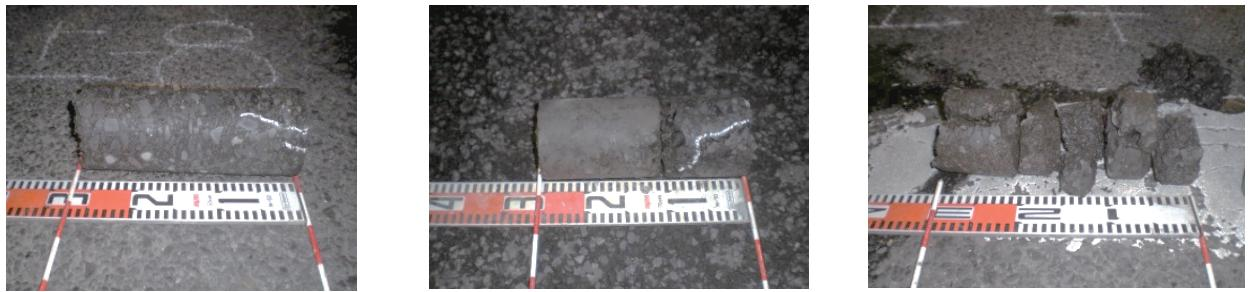
写真-1 同一現場内の抜き取りコアの状況例
