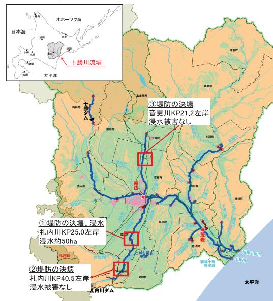
図-1 十勝川流域図<sup>4)</sup> (一部修正)
