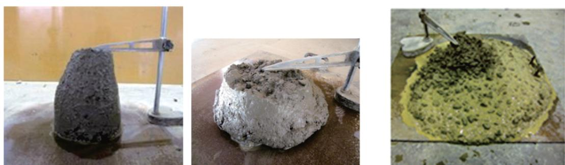
図-3 スランプの比較（左：スランプ7cm、中：スランプ19cm、右：スランプ18.5cm）
