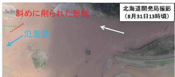
写真-7 空知川の上流決壊箇所における堤防先端の形状（赤の点線）
