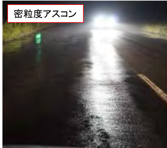
対向車ヘッドライトの路面反射光の比較 (密粒度アスコンと機能性SMA)
