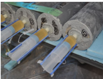
割裂ひび割れを入れた φ10×20cm円柱供試体に 樹脂系注入材を注入
