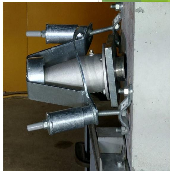
破断（飛出し）後
