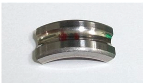
▲ ベアリング内輪部 (切断)
