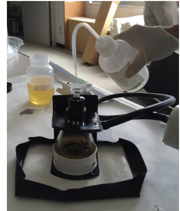
▲ エーテルで洗浄することで油分が流され、不純物だけフィルターに残る。
