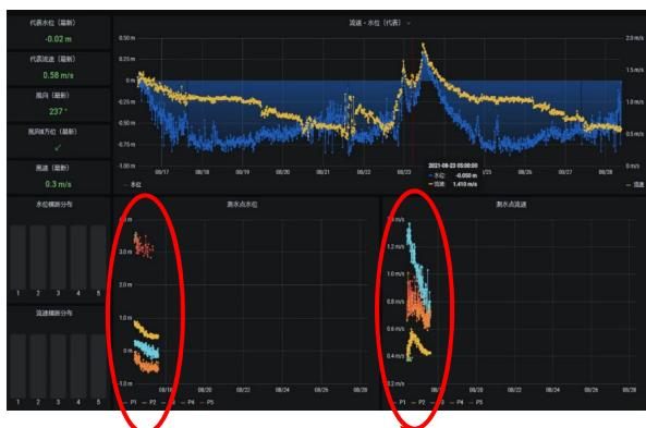
設定した水位を超えると測線毎の流速と水位を計測
