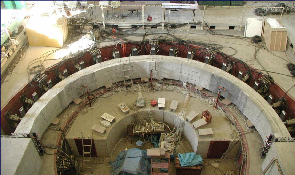
損傷を受ける前の覆工 ( $t=300\text{mm}$ 、圧縮強度  $18\text{ N/mm}^2$ ) と比較して、**耐力が約1.9倍向上**することを確認
