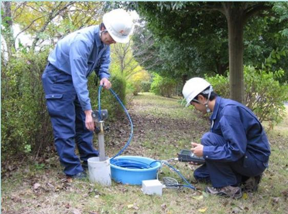
孔内傾斜計の測定状況
