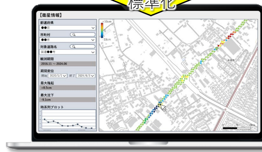
【道路施設の変状状況表示システムイメージ】
