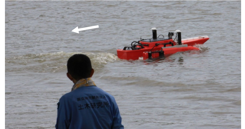
図4.2 滯筋の流速下でのラジコンボートの遡上能力の確認（2025年7月 桜川）
