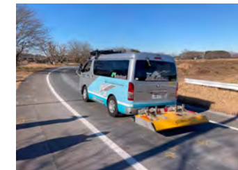
劣化にかかわる詳細データの収集例(レーダー探査)
