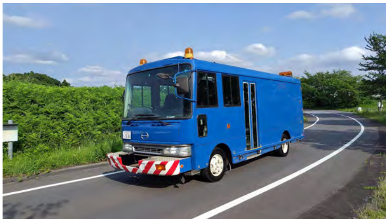
移動式たわみ測定装置（MWD）
