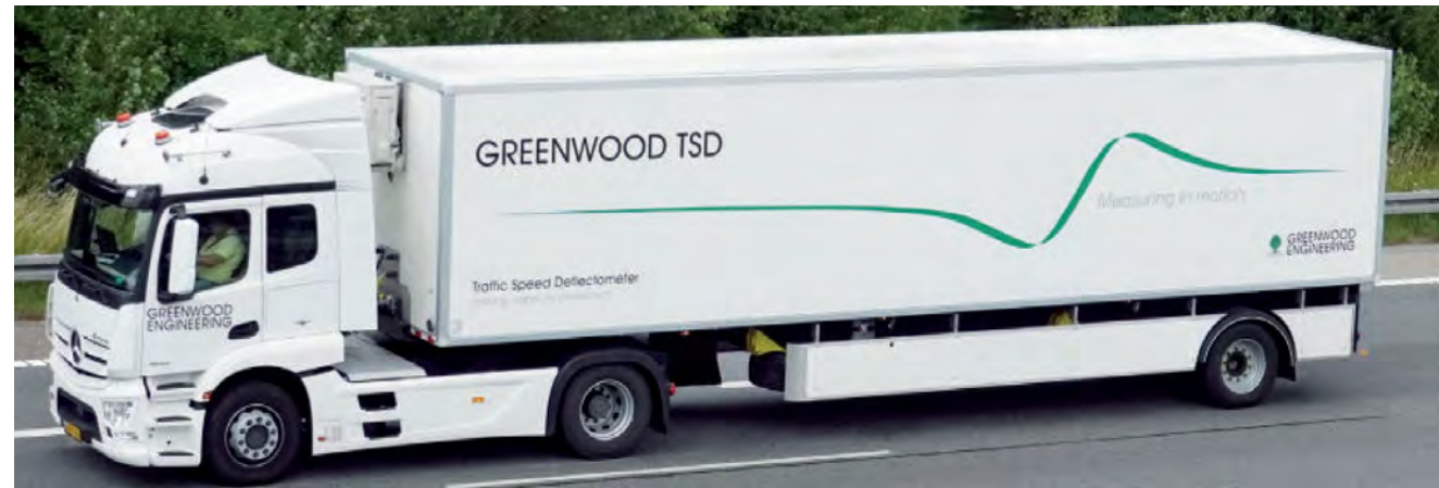
TSD 2) (Traffic Speed Deflectometer, デンマーク)
