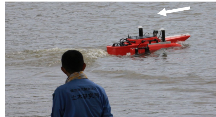
滞筋の流速下でのラジコンボートの遡上能力の確認（2025年7月 桜川）
