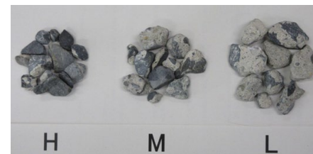
再生骨材コンクリート
