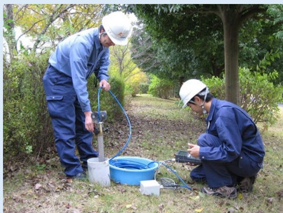
孔内傾斜計の測定状況
