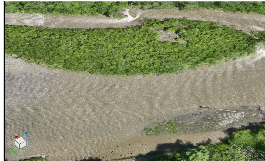
LiDARにより計測された点群（点群を標高で着色）
