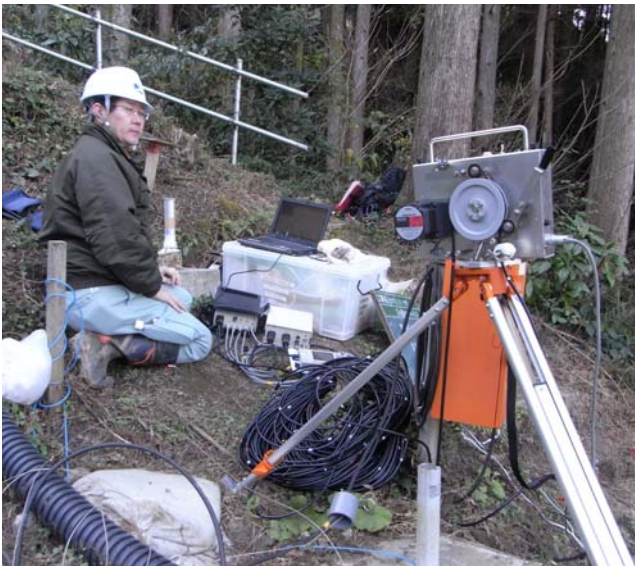
開発した地下水調査機器（加熱式地下水検層器）による地すべり調査
