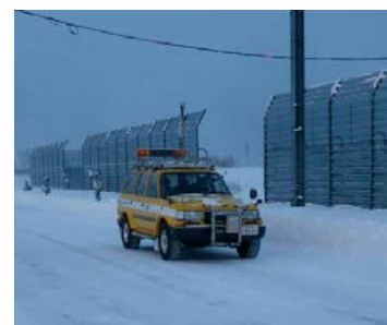
防雪柵の性能評価手法を策定するため、視程障害移動観測車で防雪柵の効果を計測
