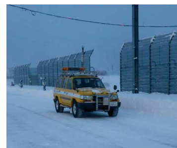
防雪柵の性能評価手法を策定するため、視程障害移動観測車で防雪柵の効果を計測
