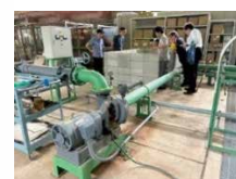
図4 逃し弁の室内実験検討の様子 (農研機構農村工学研究部門の実験室にて。同部門との共同研究を計画)
