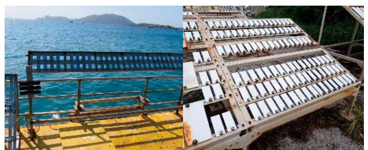
高耐候性塗料や耐食性金属材料の暴露試験による耐久性検証
