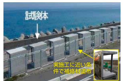
11種類の補修材を塗布したコンクリート試験体
