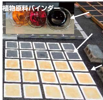
植物由来原料の舗装材料の開発 (写真は、屋外暴露試験による開発材料の耐候性評価の様子)
