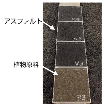
植物由来原料の舗装材料の開発 (写真は、屋外暴露試験による開発材料の耐候性評価の様子)
