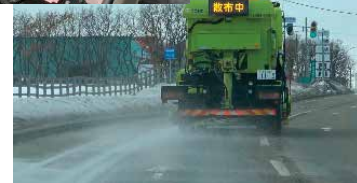
一人乗車での運用を目指して、凍結防止剤散布支援システムを開発し試験運用
